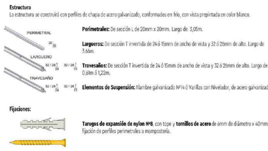
CIELORRASO SUSPENDIDO DESMONTABLE
